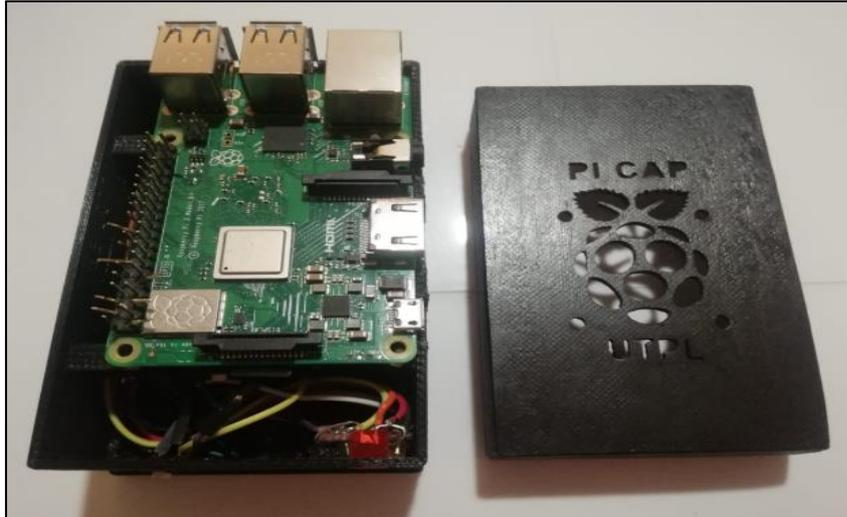
Figura 3.42. Parte superior de la tarjeta Raspberry Pi
