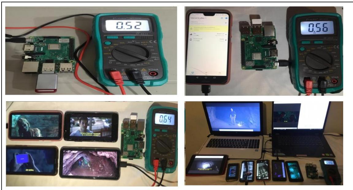
Figura 4.2. Pruebas de medición de amperaje con el multímetro MT-1210 Proskit
