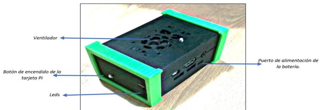
Figura. 1. Vista superior del dispositivo Pi CAP
