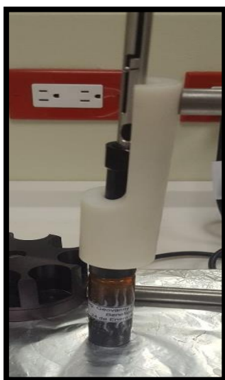
Figura 16: Extracción de compuestos aromáticos mediante HS-SPME Fuente: El autor Elaborado por: El autor
