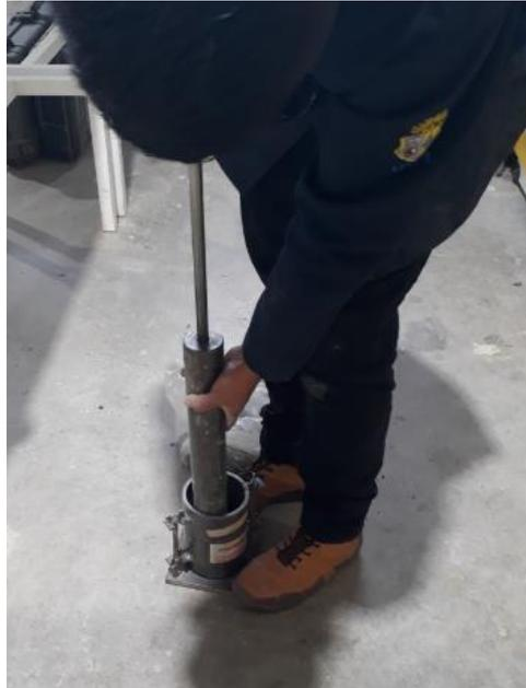
Figura 16. Compactación de la muestra alterada.
