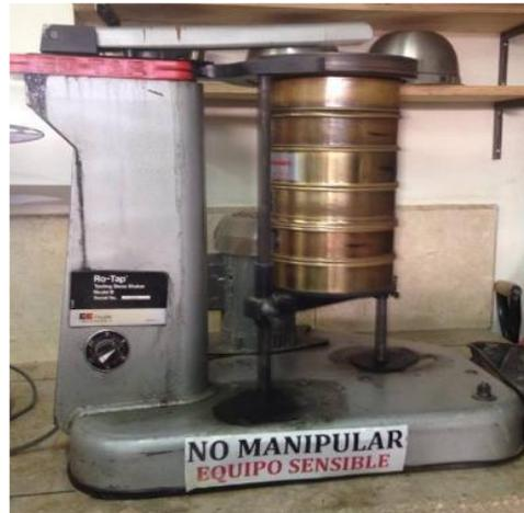
Figura 18. Ensayo de Granulometría.
