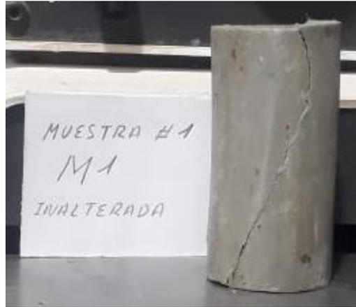
Figura 22. Tipo de falla en la probeta.
