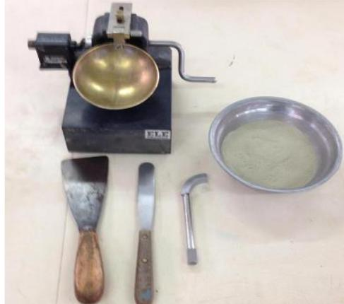
Figura 19. Ensayo de Límite Líquido
