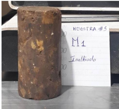
**FIGURA 97.** Probeta inalterada M1.
