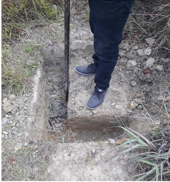
Figura 14. Extracción de muestra inalterada in situ.
