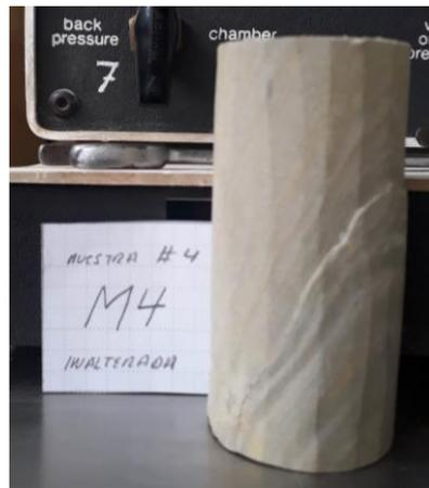
**FIGURA 82.** Probeta inalterada M4.
