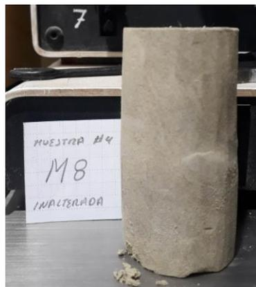
**FIGURA 86.** Probeta inalterada M8.
