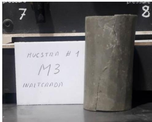
**FIGURA 27.** Probeta inalterada M3.
