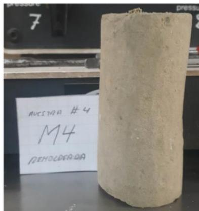
**FIGURA 91.** Probeta remoldeada M4.
