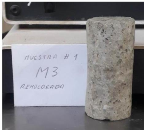
**FIGURA 36.** Probeta remoldeada M3.
