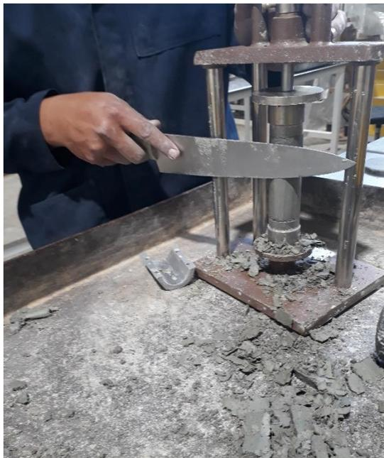
Figura 15. Determinación de probetas inalteradas.
