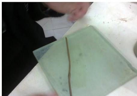
Figura 20. Ensayo de Límite Plástico.
