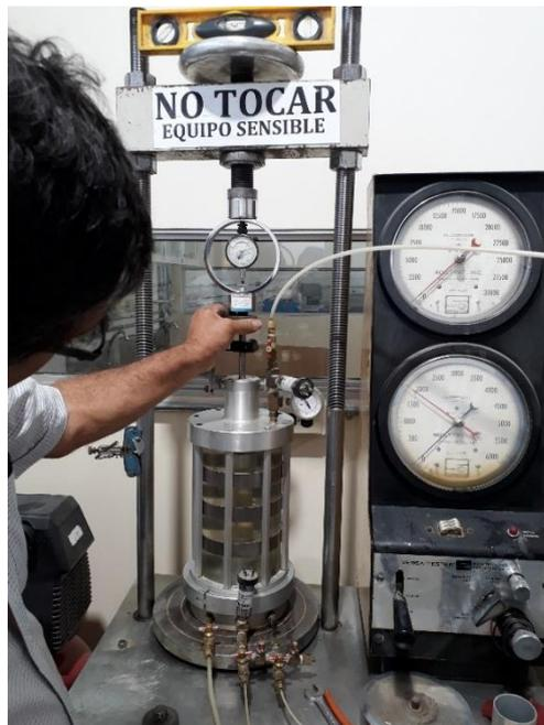
Figura 21. Realización del ensayo triaxial.
