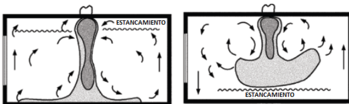
Figura 1.21.- Características del movimiento del aire para salidas del Grupo E.
