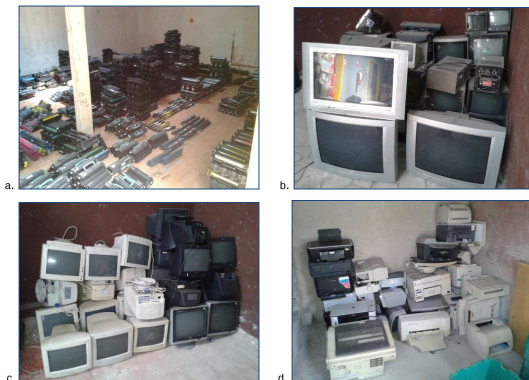
Figura 16: AEE almacenados y clasificados por el gestor de mediana escala (a) clasificación de tóneres por tipo. (b) TV de TRC. (c) monitores de TRC. (d) impresoras.
