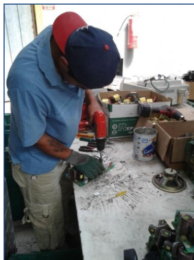
Figura 20: Proceso de desarme de AEE del gestor de mediana escala.
