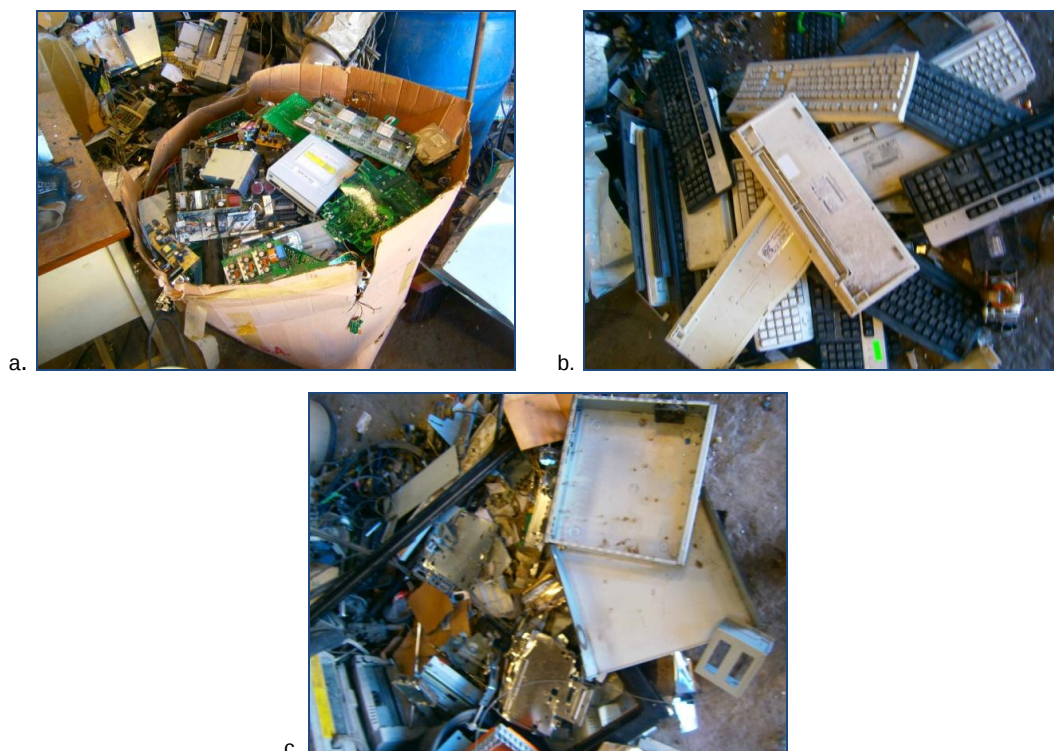
Figura 14: AEE desarmados por el gestor técnico (a) Tarjetas de circuitos integrados en contenedor. (b) teclados depositados en el suelo. (c) partes y piezas de cobre y aluminio depositados en el suelo.
