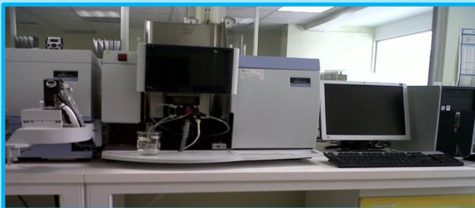
Figura 14.15. Determinación de oro por Espectrofotometría de absorción atómica.
