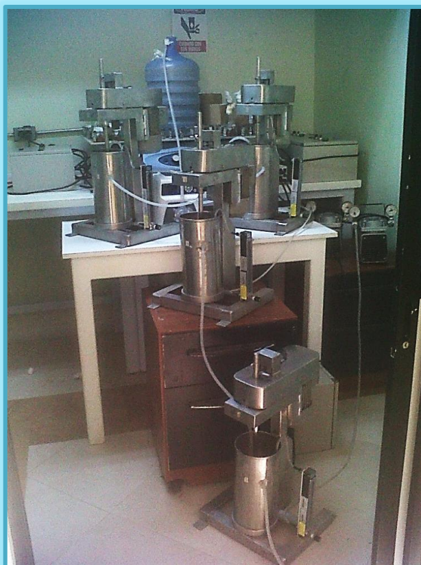
Figura 5.2. Configuración de los reactores del sistema continuo.
