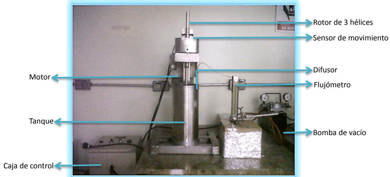
Figura 5.1. Partes de un reactor de tanque agitado.
