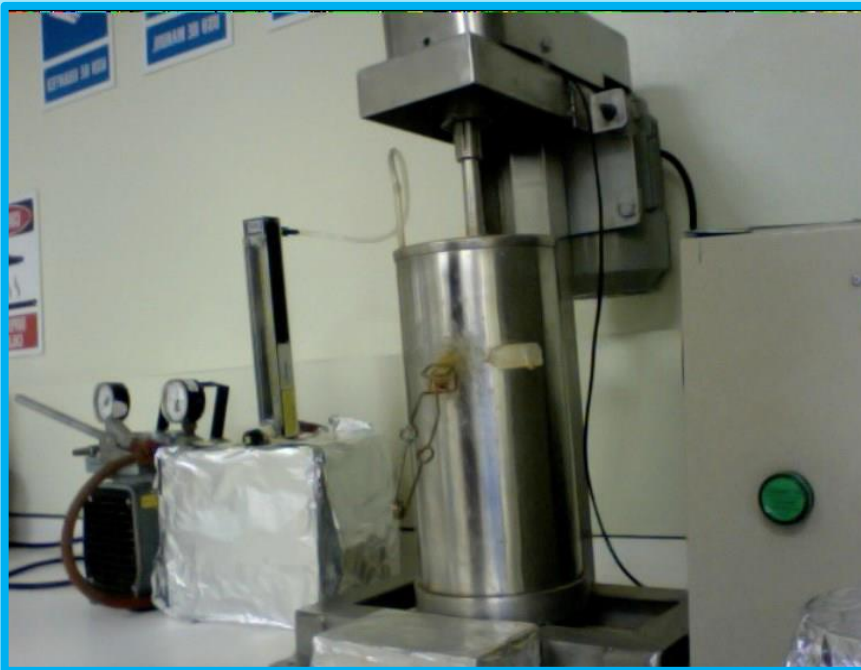
Figura 14.7. Sistema Por lote de biooxidación.
