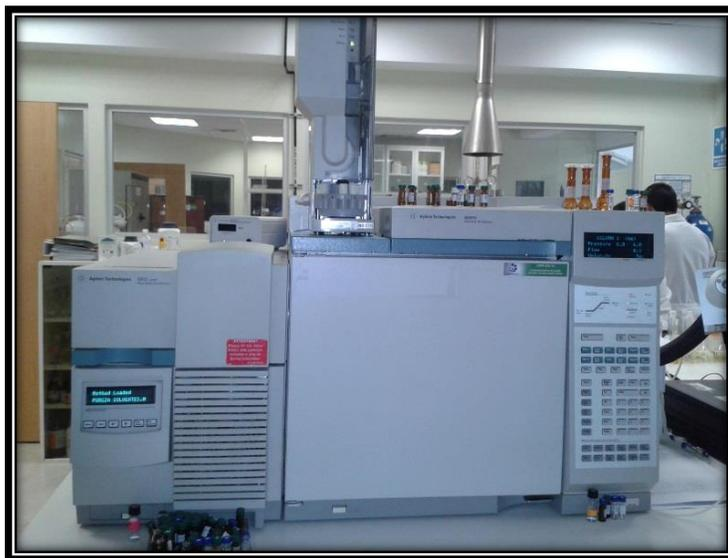
**Figura 3:** Cromatógrafo de Gases Agilent serie 6890N
