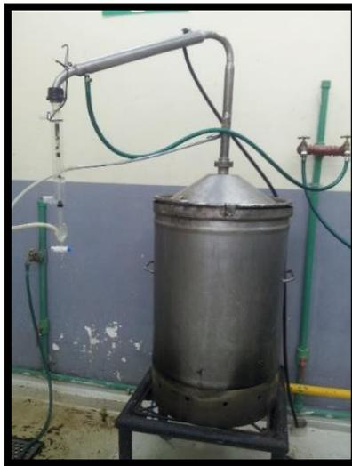
Figura 7. Equipo de destilación por arrastre de vapor.
