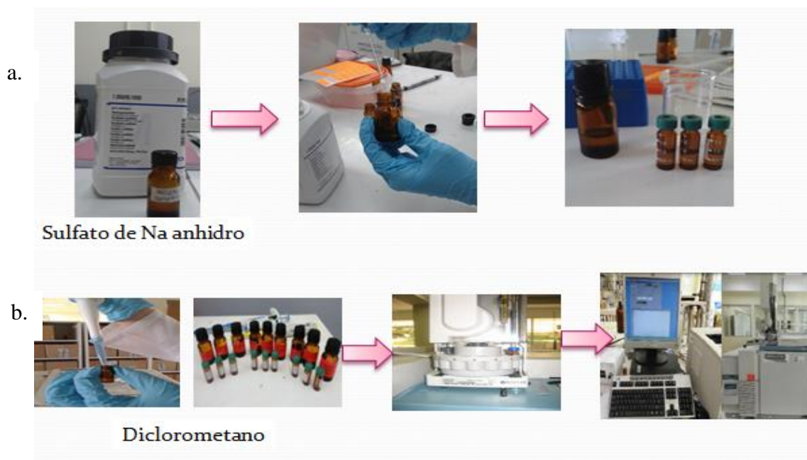
Figura 19: a) Extracción de agua existente en el aceite b) mezcla del aceite con el Diclorometano.
