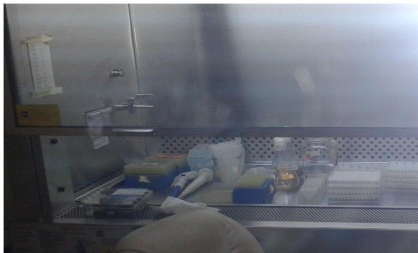
Figura 26: Limpieza y desinfección de la cámara de trabajo
