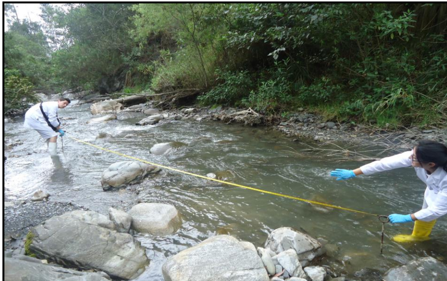
Fotografía 3. Aforo en la descarga Punzara mediante el molinete portátil. Fuente: Autora
