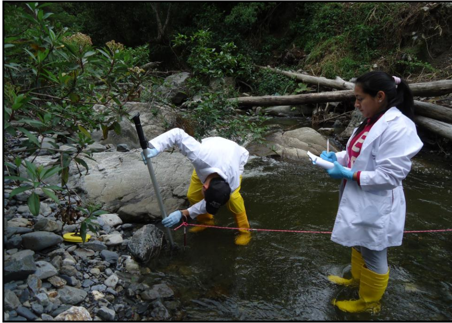
Fotografía 2. Aforo en el Punto Quebrada Mónica utilizando el molinete portátil. Fuente: Autora
