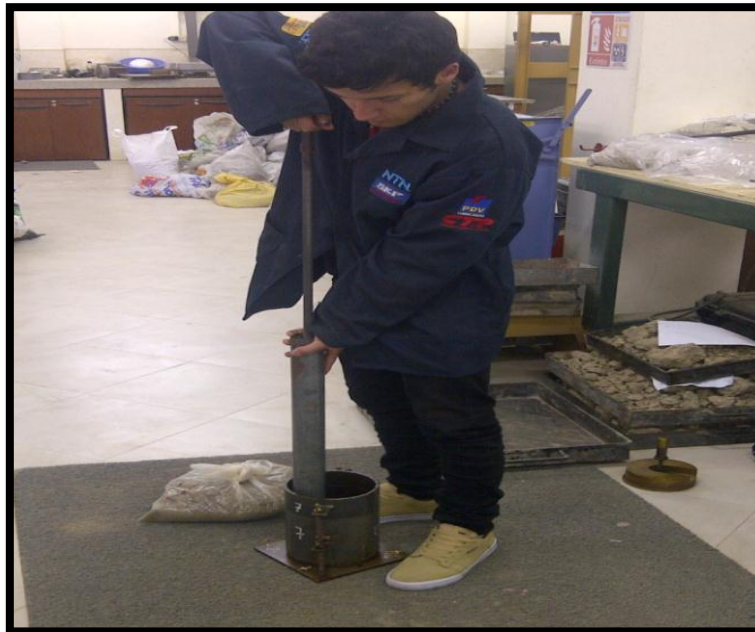
Fotografía 13: Caída libre del martillo de 8 Kg. Energía de compactación de 56000 lb/pulg.2
