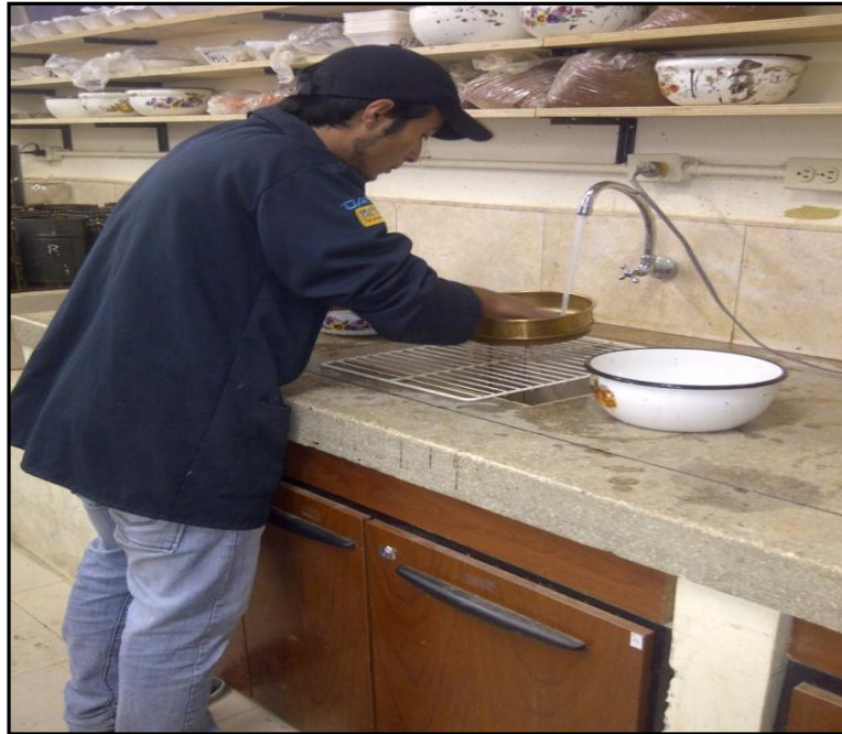
Fotografía 9 Eliminación del material fino mediante lavado
