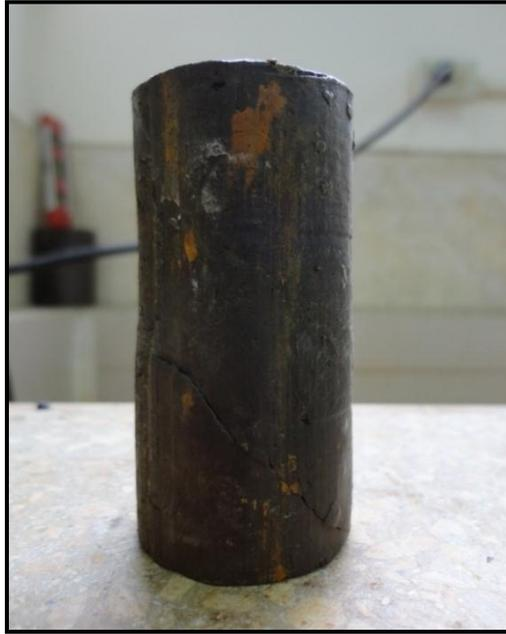
**Imagen 2.3** Muestra-probeta de ensayo Triaxial
