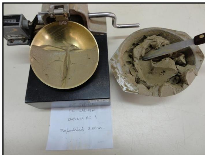
**Imagen 2.2** Ensayos de laboratorio. Límite líquido
