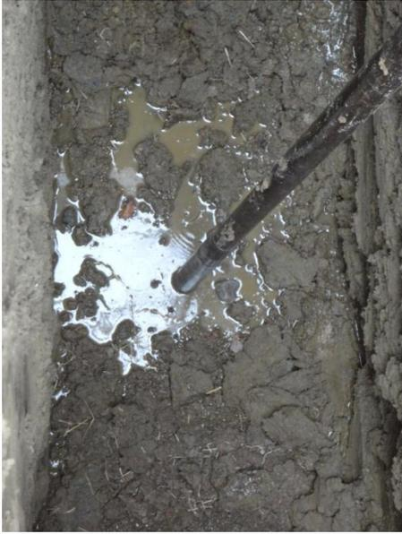
**Fotografía I.4.** Calicata: Presencia de nivel freático a 4 m.
