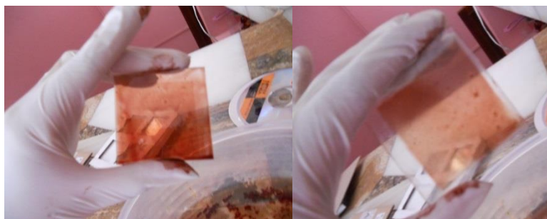
Figura 15. Celda sensibilizada con el colorante natural
