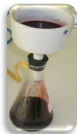
Figura 9. Filtración al vacío del colorante
