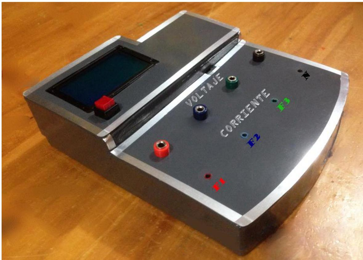
Figura 4.12 Prototipo analizador de calidad de energía eléctrica.
