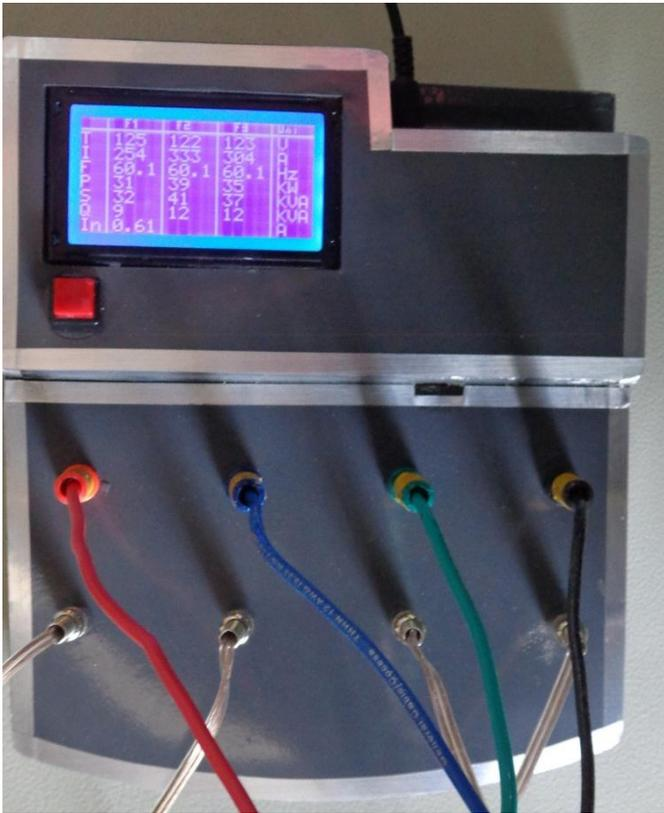
**E.7. Prototipo analizador de calidad de energía eléctrica implementado en funcionamiento**
