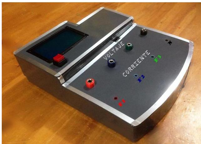
Fig. 12. Prototipo analizador de calidad de energía eléctrica. Fotografía de los autores.
