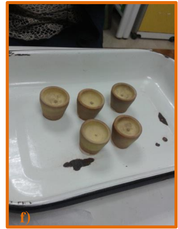
Foto 10.- Fusión Copelación: a) Mezcla Fundente, b) Nitrato de plata ( \text{AgNO}_3 ), c) Proceso de fusión, d) Colocación de la muestra fundida en las payoneras , e) Producto de la Fusión y enfriamiento en las payoneras (escoria y regulo) , f) Muestras copeladas (perlas mineralizadas de Au, Ag)
