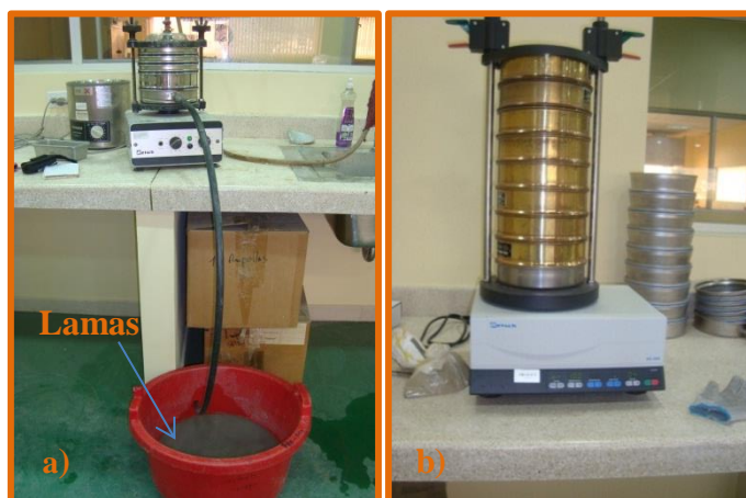
Foto 9.- Análisis granulométrico: a) Análisis granulométrico en húmedo, b) Análisis granulométrico en seco Fuente: Espinoza, 2014
