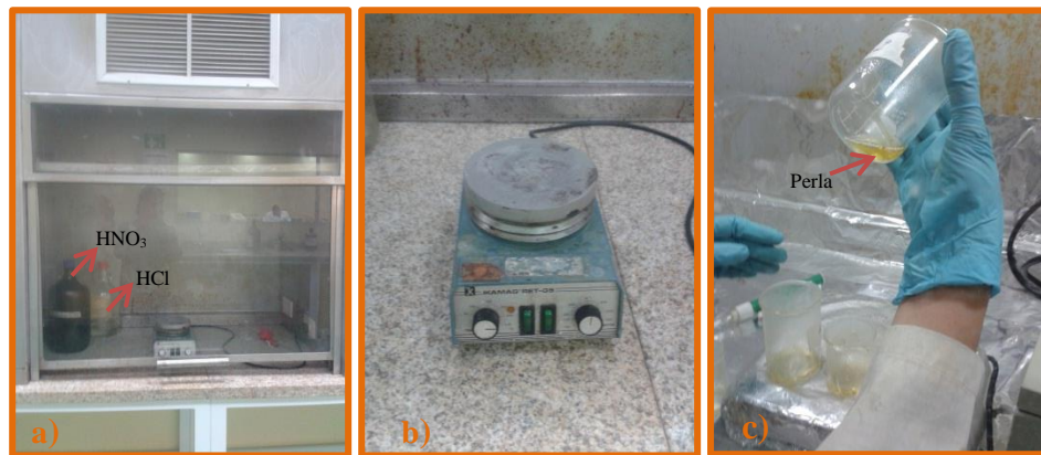
Foto 11.- Digestión: a) Ácido Nítrico y Ácido Clorhídrico, b) Plancha calentadora, c) Digestión de la perla en Agua Regia. Fuente: Espinoza, 2014
