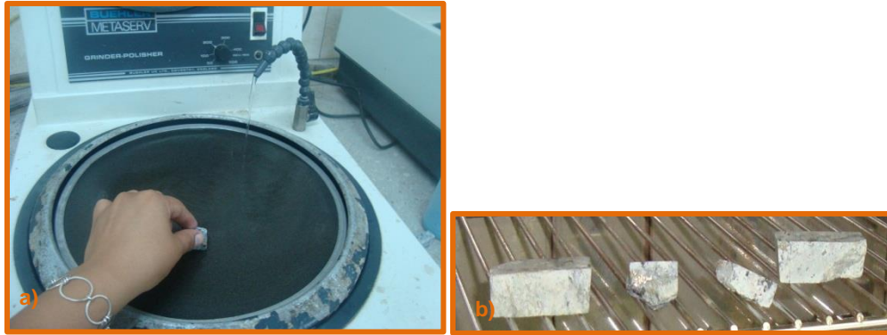
Foto 8.- Sección Pulida: a) Pulido de la muestra, b) Muestra pulida y seca Fuente: Espinoza, 2014
