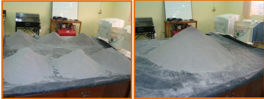
Foto 7.- Homogenización y cuarteo de las muestras Fuente: Espinoza, 2014
