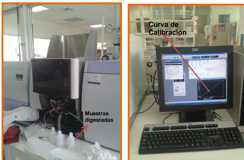
Foto 12.- Lectura de las muestras: a) Equipo de Espectrometría de absorción atómica de llama, b) Programa de lectura de datos. Fuente: Espinoza, 2014
