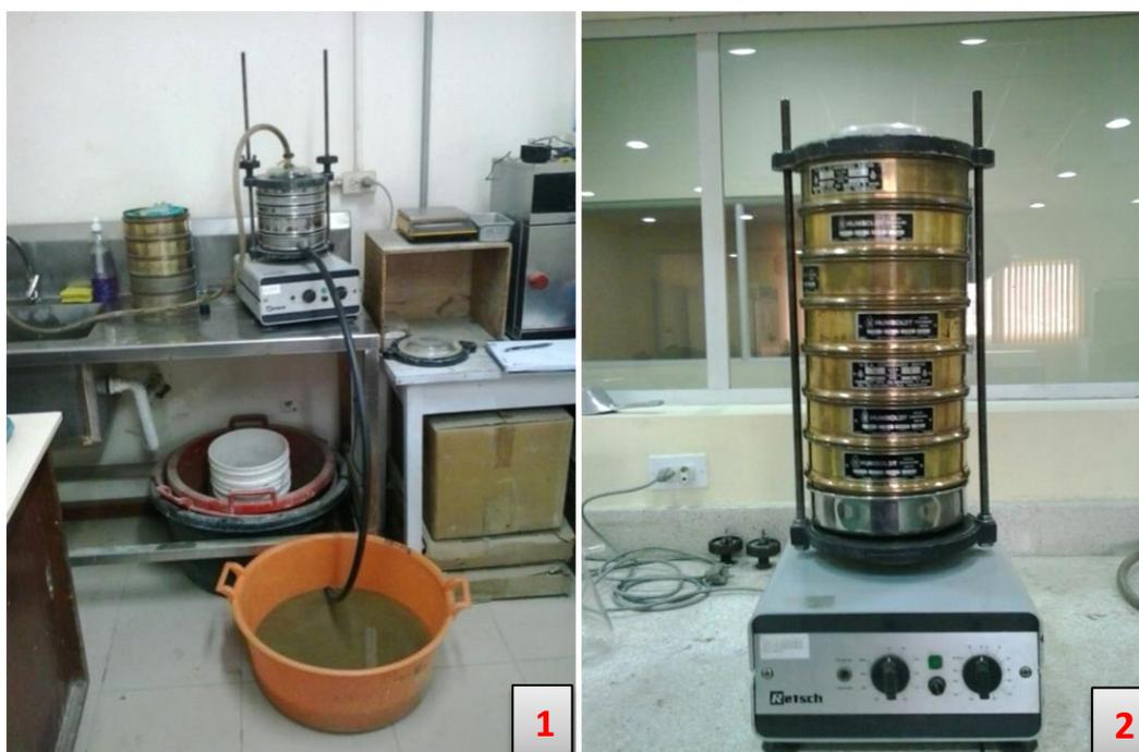
Imagen 7. Ensayo Granulométrico: 1) Granulometría por vía húmeda; 2) Granulometría por vía seca. Código de muestra: LP-M1
