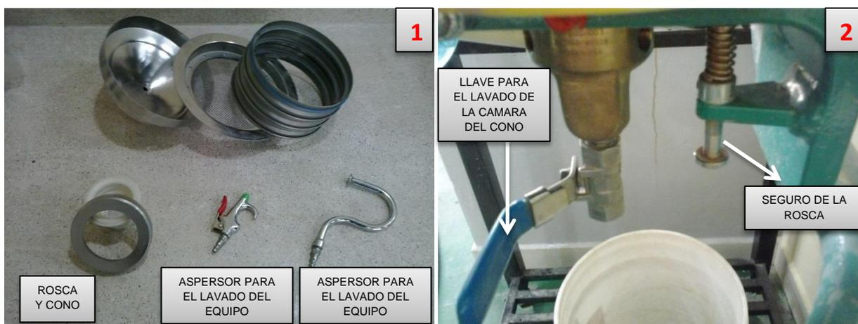
Imagen 13. Partes del equipo Knelson: 1) Accesorios y aspersores; 2) Llave para el lavado de la cámara del cono (izquierda) y seguro de la rosca (derecha).
