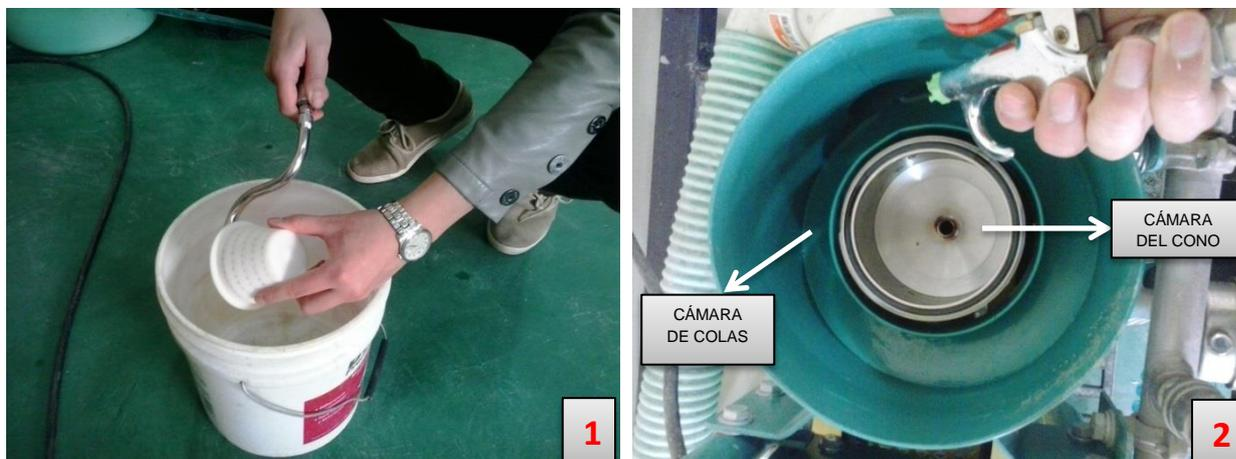
Imagen 14. Lavado del equipo Knelson: 1) Lavado del cono con concentrado; 2) Lavado de la cámara del cono y cámara de relaves.
