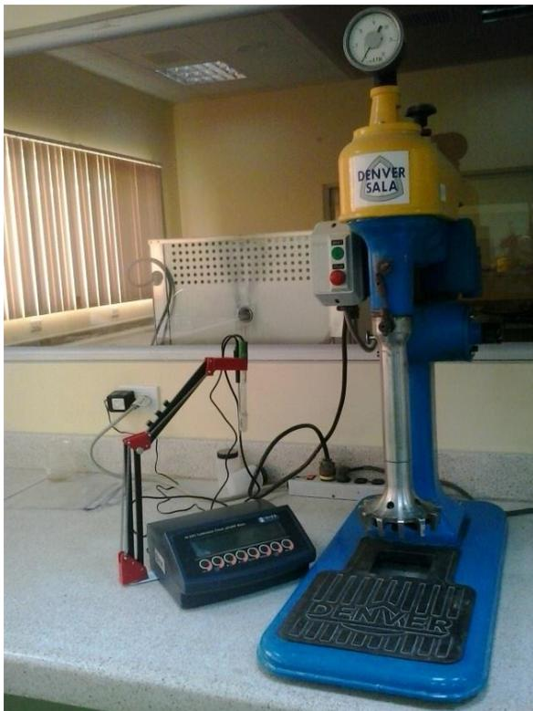
Imagen 11. Celda de flotación (derecha);
