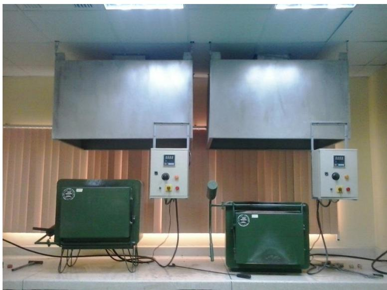
Imagen 8. Muflas de fusión (izquierda) y copelación (derecha).
