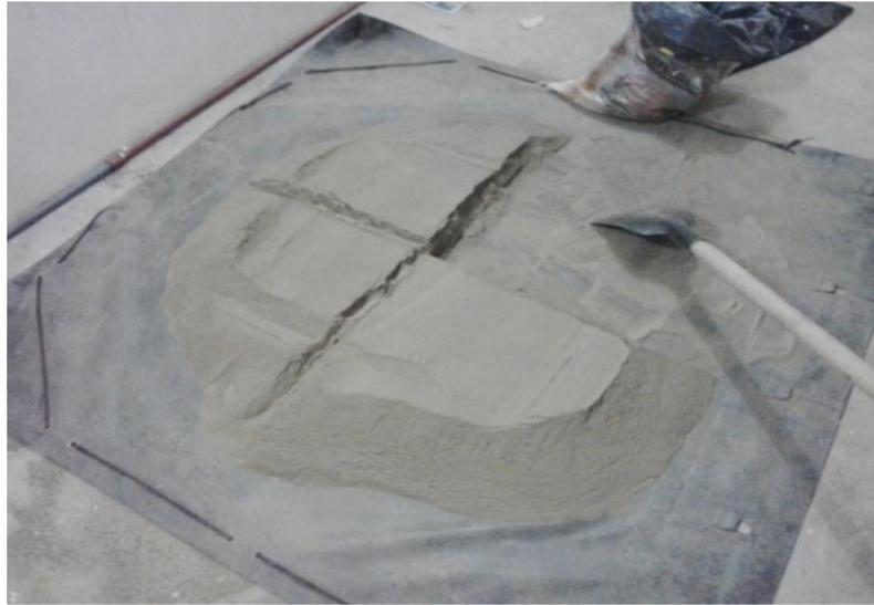
Imagen 5. Homogenización y cuarteo del material. Código de Muestra: Rel.L.P.1.
