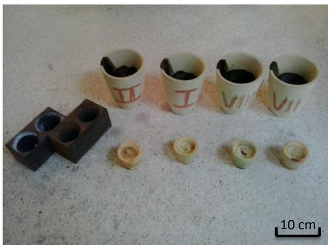
Imagen 9. Payoneras de acero, crisoles y copelas.
