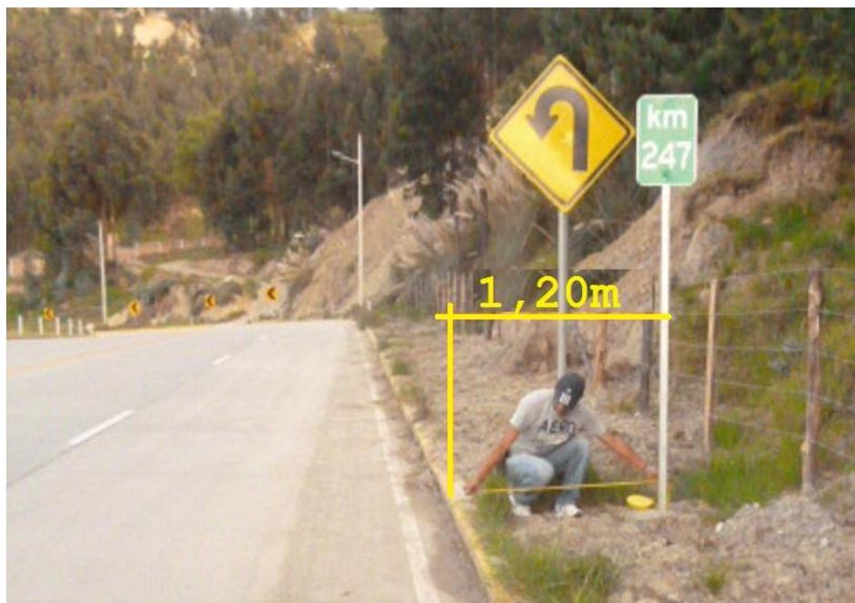
**Figura 7:** Medición de señales informativas en el kilómetro 2+047
