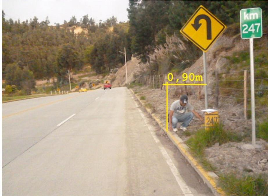
**Figura 6:** Medición de señales reglamentarias en el kilómetro 2+047
