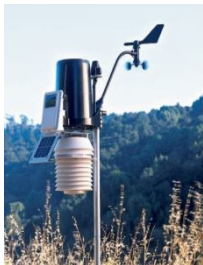
Figura 2.1 El Módulo de Sensores Integrados
