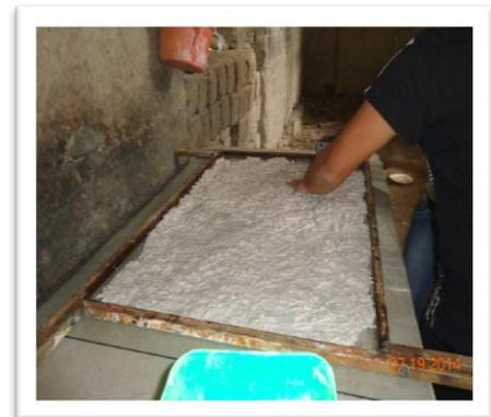
**Fig.5.16** Vertido del material en el molde.
