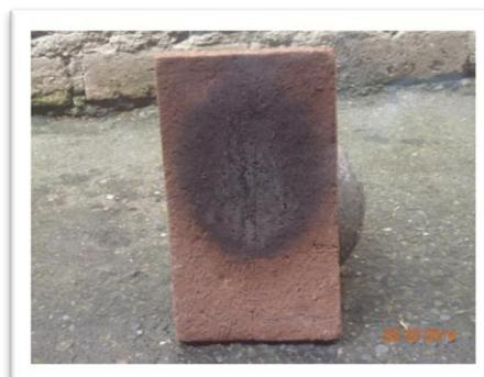
**Fig.4.28** Tablero de bondex-bagazo, sometido a prueba de fuego
