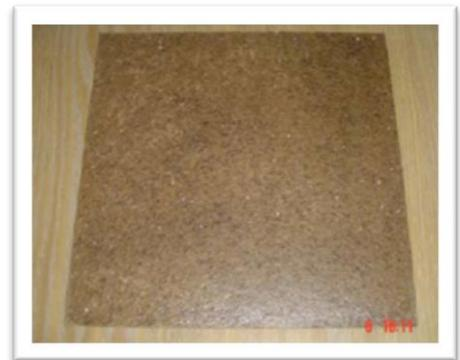
Fig.3.9 Tablero de fibra de coco-plástico.
