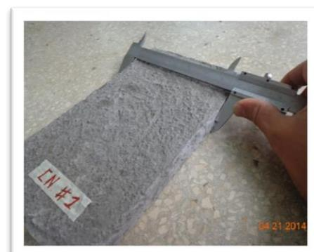
Fig.4.18 Medición de probetas, pruebas a flexión.
