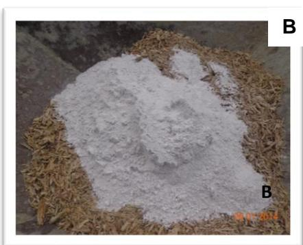
Fig.5.10 A) yeso de cantera, B) dosificación bagazo-yeso
