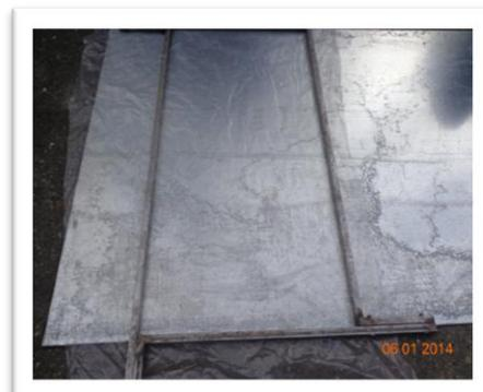
Fig. 5.9 Moldes metálicos para tableros
