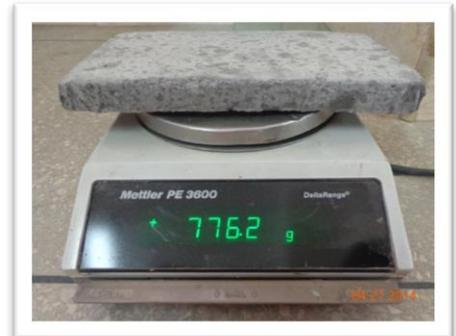
Fig.4.19 Pesaje de probetas, pruebas a flexión.
