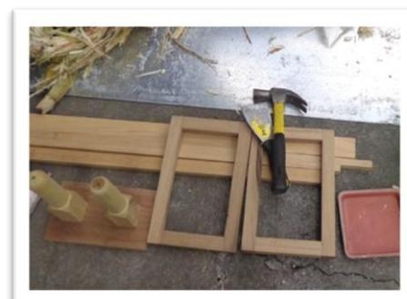
Fig.4.17 Moldes para probetas, pruebas a flexión.
