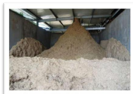
Fig.1.37 Bagazo desmedulado almacenado briquetas.
