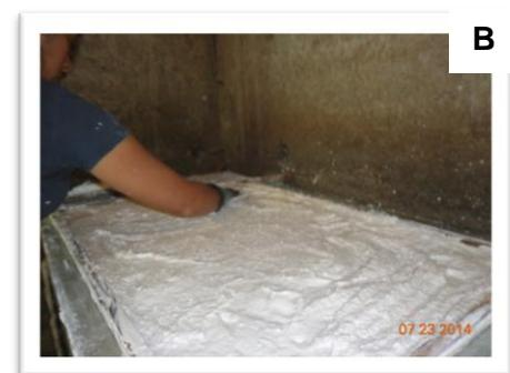
Fig. 5.11 Elaboración de tablero yeso-bagazo
