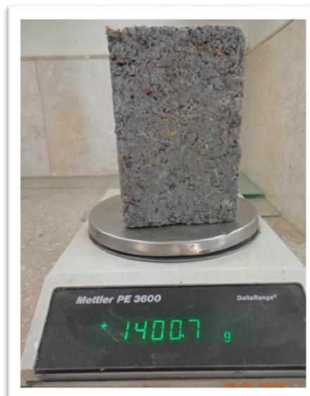
Fig.4.13 Pesaje de probetas.
