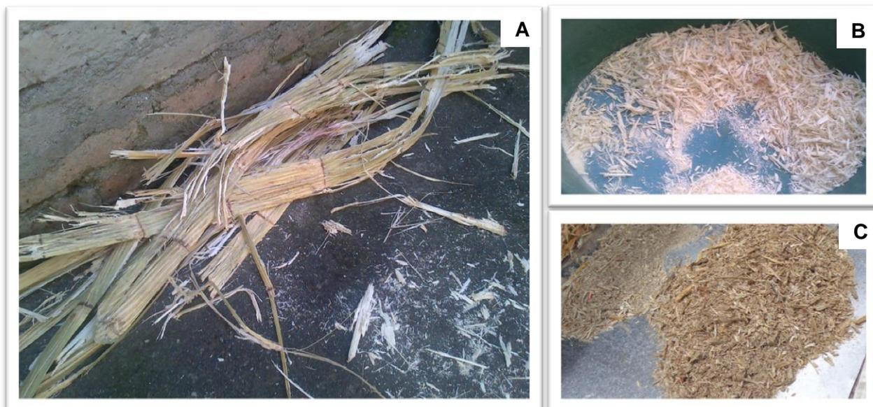
**Fig.4.10** Clasificación del material, A) fibra entera, B) pulpa, C) partículas
