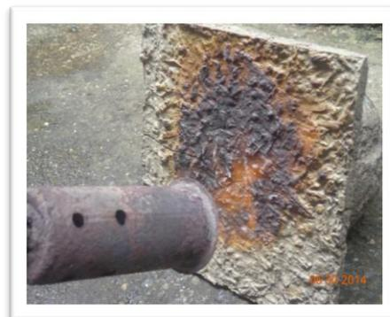
**Fig.4.27** Tablero de cemento-bagazo, sometido a prueba de fuego
