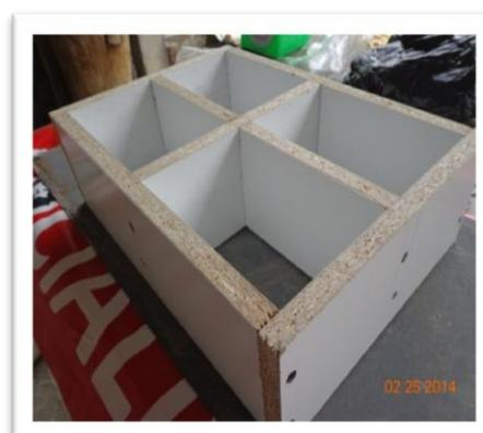
Fig.4.11 Moldes de madera para pruebas a compresión.
