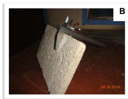
Fig.4.22 Medición de probetas, prueba de hinchamiento.
