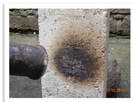
Fig.4.26 Tablero de yeso-bagazo, sometido a prueba de fuego
