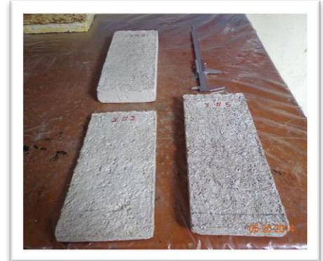
**Fig.4.23** Tableros antes de medir su espesor inicial.
