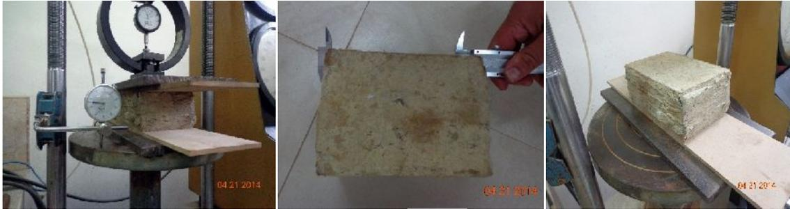
**Figura 4.4:** Ensayo mecánico a compresión, determinando antes las medidas de las probetas. Fuente: Autor
