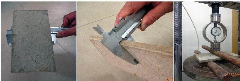
**Figura 4.3:** Ensayo mecánico a flexión, determinando antes las medidas de las probetas. Fuente: Autor
