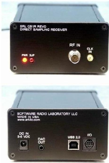
Figura 2.4. Dispositivo SRL QuickSilver QS1R
