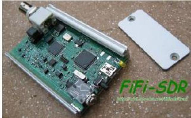
Figura 2.6. Dispositivo FiFi SDR.
