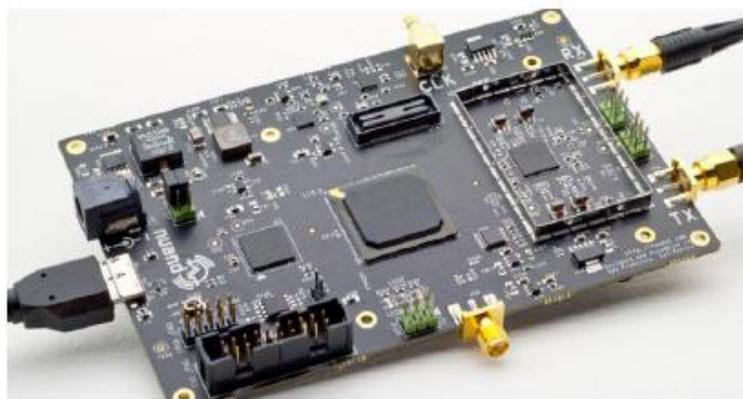
Figura 2.7. Dispositivo bladeRF.
