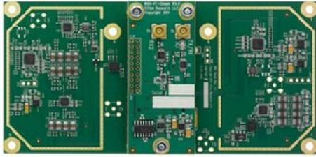
Fig. 4. Imagen de la tarjeta WBX. Imagen tomada de [5]
