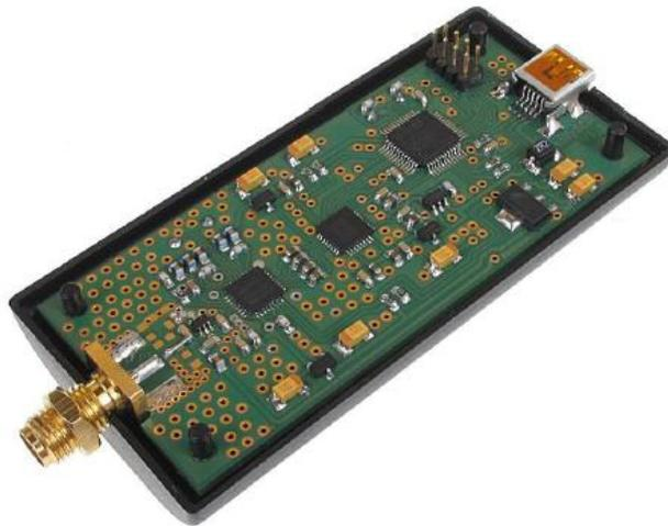
Figura 2.8. Dispositivo easySDR.
