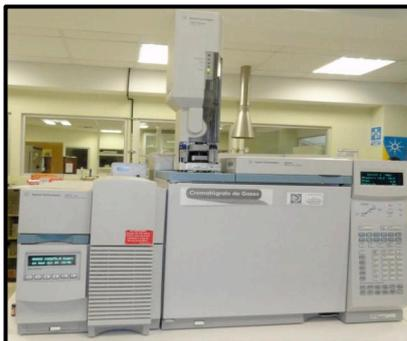
**Figura 12.** Cromatografía de gases acoplado a espectroscopia masas
