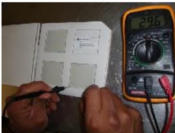
**Fig. 14.** Verificación del lado conductor del electrodo a utilizar. Fotografía de los autores.
