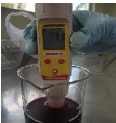
Figura 2.14. Medición de pH de una de las muestras de colorante.
