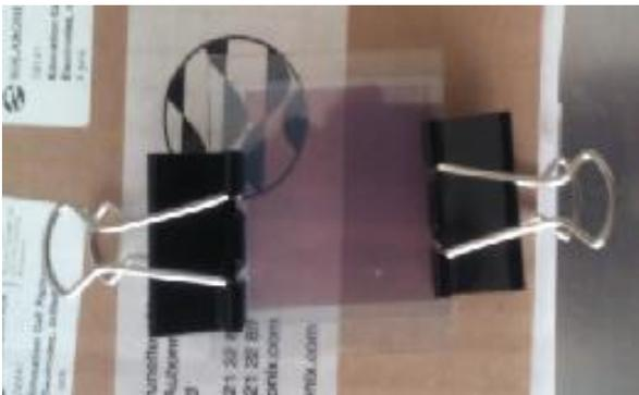
**Fig. 19.** Unión del electrodo y del contra - electrodo. Fotografía de los autores.
