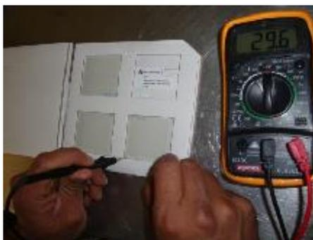
Figura 2.15. Verificación del lado conductor del electrodo a utilizar.
