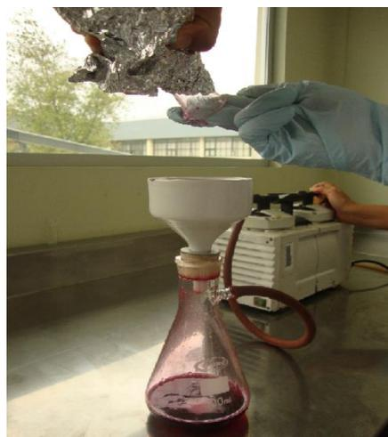
**Fig. 12.** Filtrado con válvula de vacío. Fotografía de los autores.
