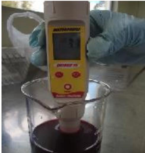
**Fig. 13.** Medición del pH de una de las muestras de colorante. Fotografía de los autores.
