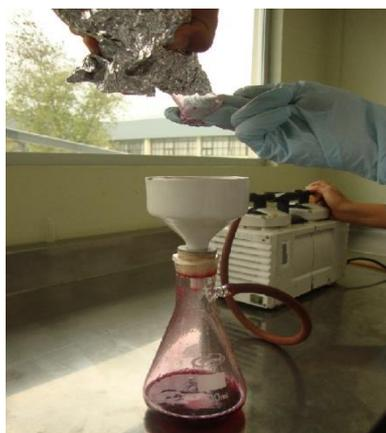
Figura 2.13. Filtrado con válvula de vacío.
