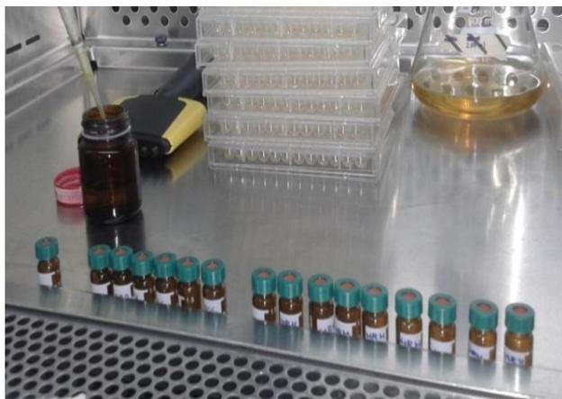
**Figura 20.** Muestras de aceite diluido con Dimetil sulfóxido.
