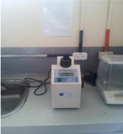
**Figura 6.** Refractómetro ABBE
