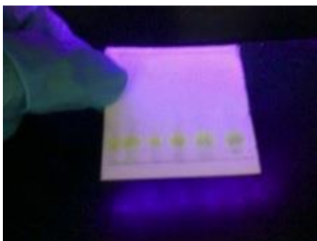
Figura 12. CCF en fase inversa RP18 (MeOH/H 2 O 7:3). De der. a izq. las fracciones sembradas de la 30 a la 35.a luz UV 365 nm
