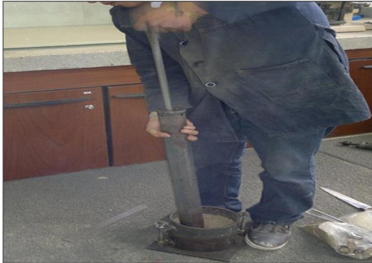
**Fotografía 5.7.** Elaboración del ensayo de compactación proctor.
