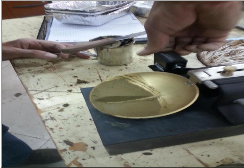
**Fotografía 5.5.** Elaboración del ensayo de Limite Líquido.
