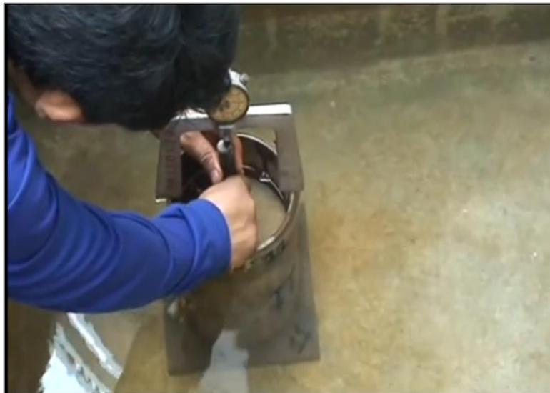
**Fotografía 5.8.** Colocación de la muestra en agua para el ensayo de C.B.R.
