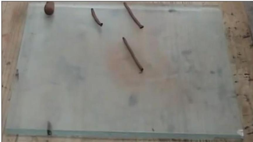
**Fotografía 5.6.** Elaboración del ensayo de Limite Plástico.
