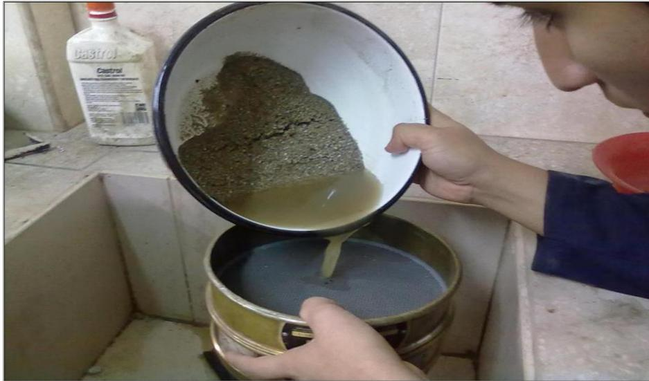
**Fotografía 5.3.** Lavado del material por el tamiz N.- 200 para realizar el ensayo de granulometría mediante material fino.
