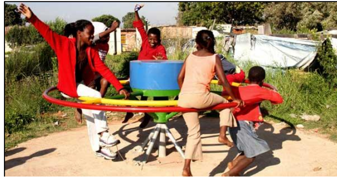
Figura 3.1 Play Pump, una atracción infantil para bombear agua con energía humana y diversión. Fuente: http://www.terra.org/categorias/articulos/aplicaciones-domesticas-con-energia-humana .
