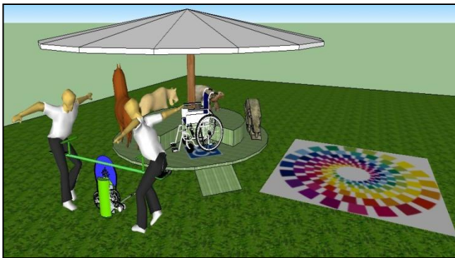
Fig 5. Panorámica de la propuesta del carrusel accionado por padres para el RPJ. Diseño de los autores.
