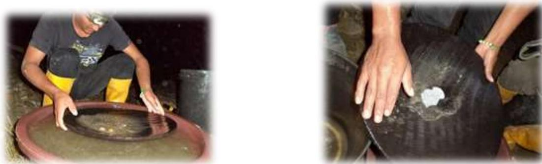
**Imagen 24.** Colocación de Mercurio sobre el oro
