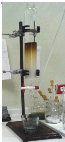
Figura 16. Columna del extracto desclorofilado de acetato de etilo Fuente: La autora, 2015
