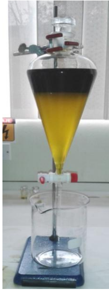
Figura 15. Desclorofilación del extracto de acetato de etilo
