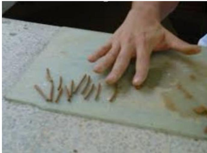
**Fotografía 3.4.** Realización del ensayo de límite plástico.
