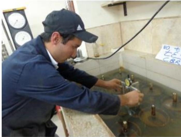
**Fotografía 3.9.** Medición del hinchamiento, ensayo de CBR.
