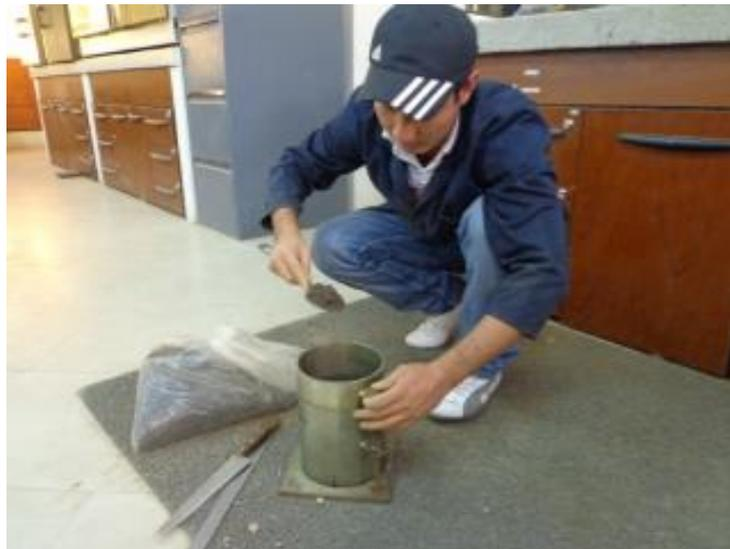
**Fotografía 3.8.** Realización de la compactación para el ensayo de CBR.
