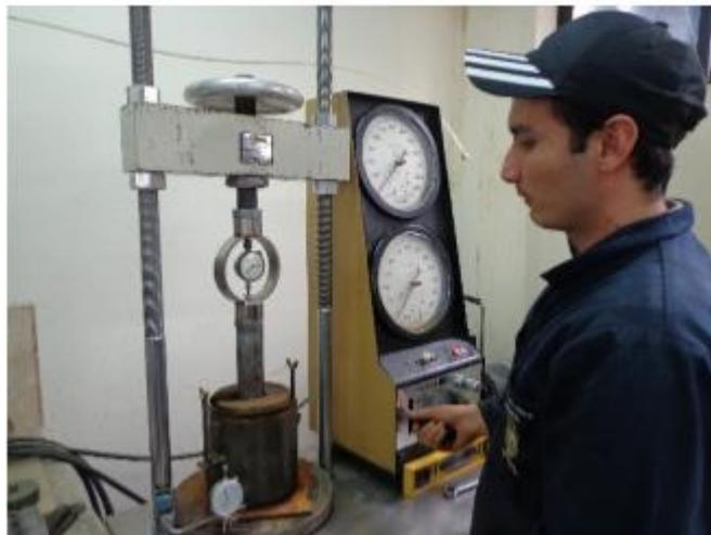
**Fotografía 3.10.** Ensayo de penetración de CBR.
