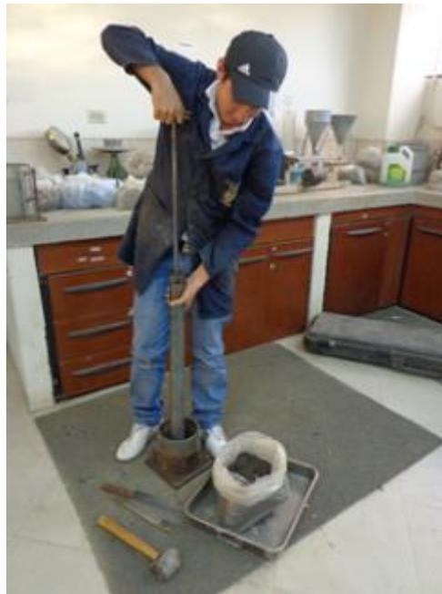
**Fotografía 3.7.** Realización del ensayo de compactación Proctor modificado.
