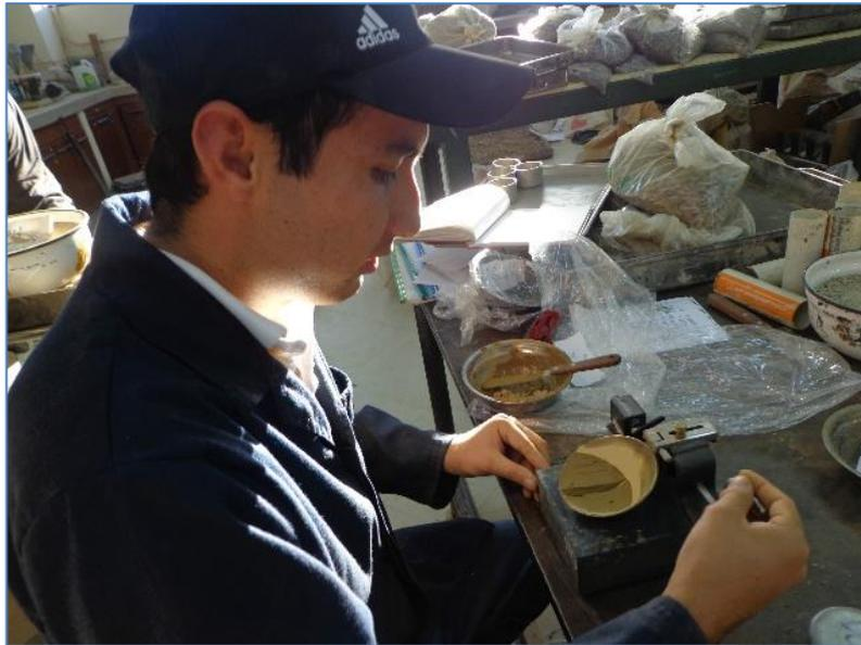
**Fotografía 3.3.** Realización del ensayo de límite líquido.
