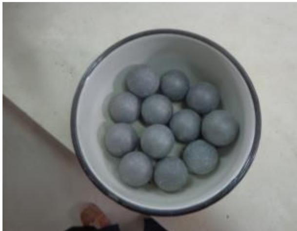
**Fotografía 3.11.** Esferas para el ensayo de abrasión.
