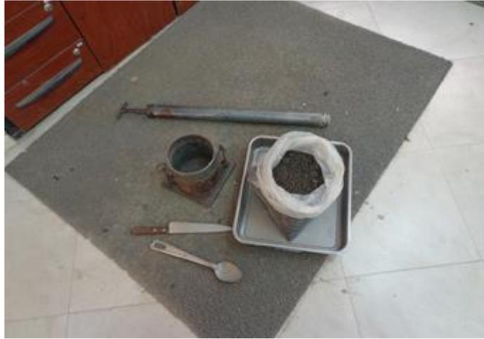
**Fotografía 3.6.** Equipo utilizado para la compactación Proctor.
