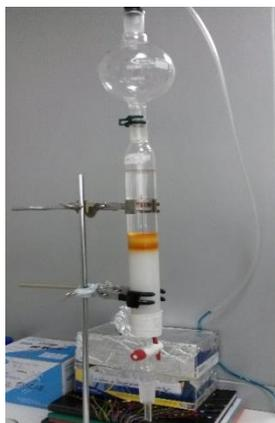
**Figura 15: Columna comatográfica.**
