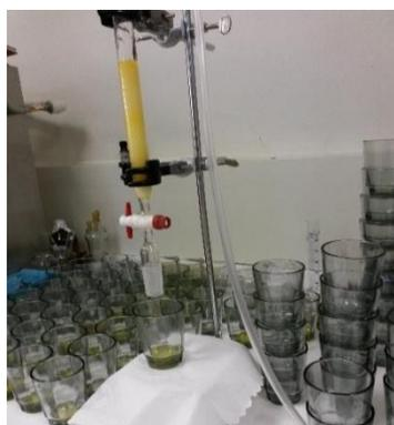
**Figura 14:** Columna cromatográfica.
