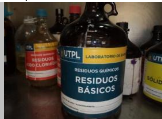
a. Recipientes temporales para residuos peligrosos líquidos
