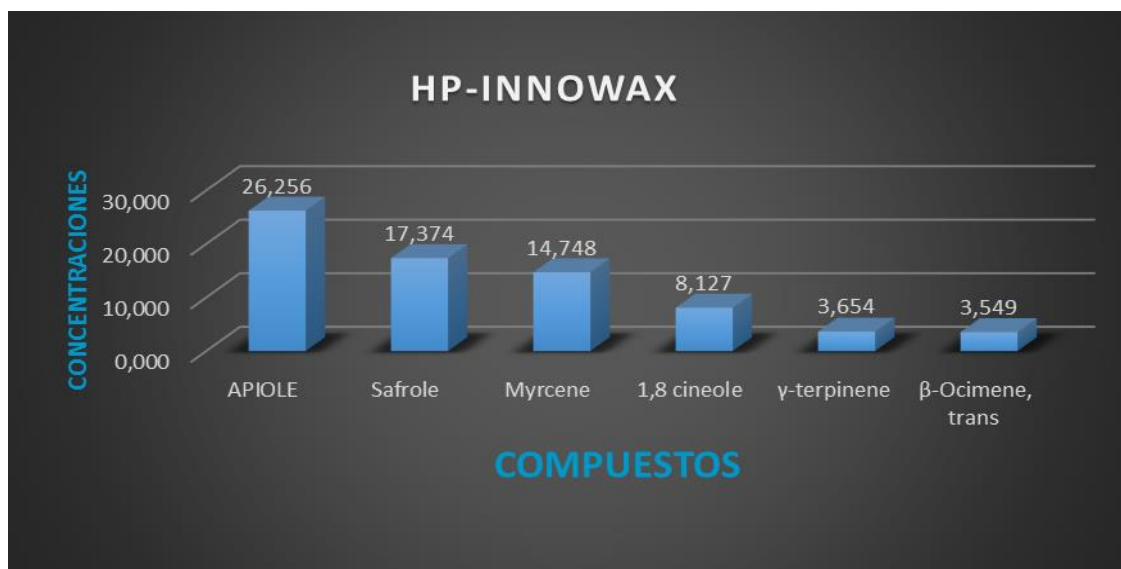
Figura 22: Compuestos mayoritarios en la columna HP-INNOWAX
