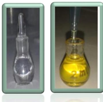
Figura 6: Determinación de la densidad relativa a) Picnómetro con agua y b) Picnómetro con aceite.
