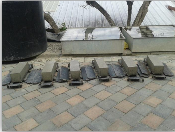
Fotografía 8.4. Desmoldado de vigas.
