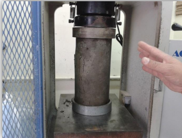
Fotografía 8.7. Ensayo de resistencia a compresión de probetas cilíndricas.
