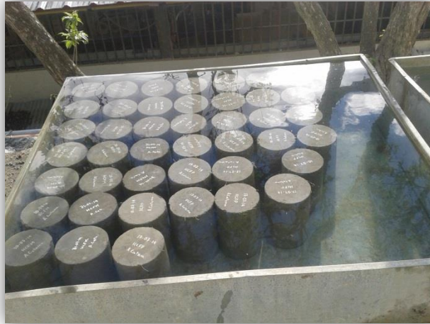
Fotografía 8.5. Curado de probetas cilíndricas.
