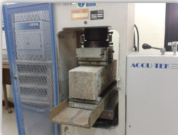
Fotografía 8.9. Ensayo de resistencia a flexión en vigas apoyadas en los extremos y cargadas en los tercios de la luz libre.
