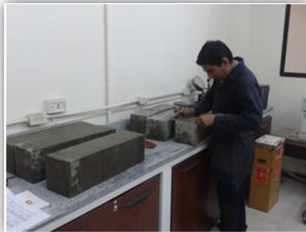
Fotografía 8.8. Preparación de vigas para ser ensayadas.
