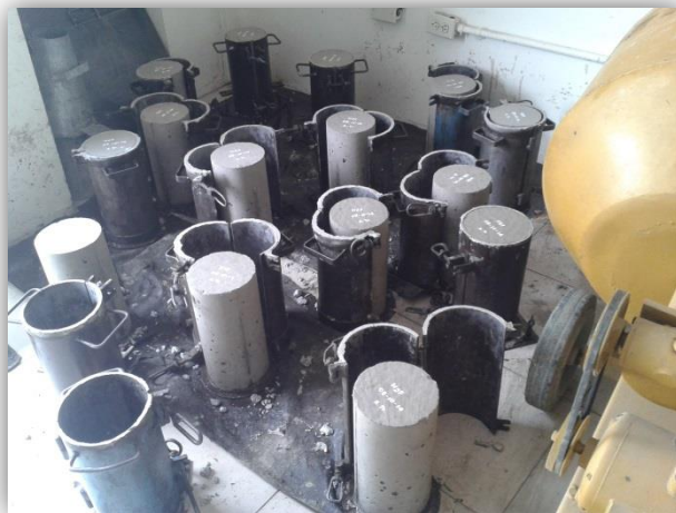
Fotografía 8.3. Desmoldado de probetas cilíndricas.
