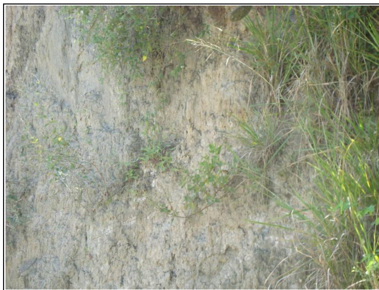
Foto No. 12: Depósitos Coluviales matriz arcillosa con clastos de pizarras y esquistos verdes
