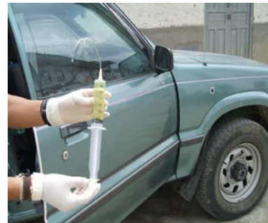
Manipulación de la muestra de aceite del transformador
