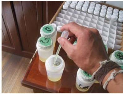
Extracción del aceite para el análisis
