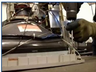
Fig. V.5 Desmontaje de carcasa
