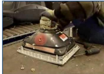
Fig. V.7 Extracción de yugo
