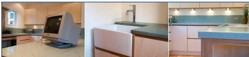
Fig. 8.7 Vidrio reciclado de TRC en mostrador y lavabo de cocina<sup>20</sup>
