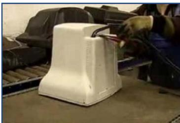
Fig. V.4 Corte de cables de alimentación<sup>10</sup>
