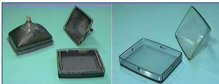
Fig. 8.6 Vidrio de TRC luego de la aplicación del método de lavado humedo<sup>19</sup>
