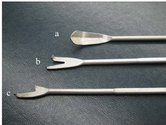
Figura 5. Herramientas modificadas. a. herramienta para manipular protocormos, b. herramienta para repique y siembra de plántulas, c. herramienta para siembra de plántulas.
