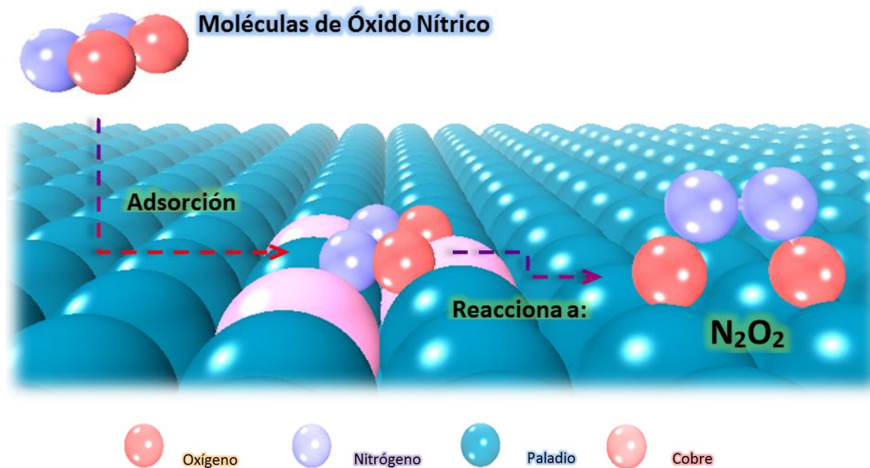
Figura N° IV-IX. Reacción entre 2 moléculas de NO catalizada por superficies bimetalicas para la formación de N 2 O 2
