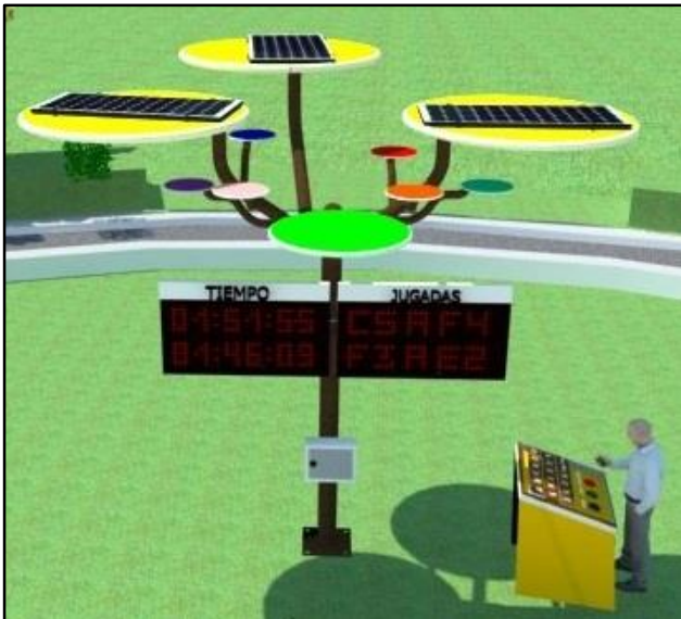
Fig.18. Árbol fotovoltaico para provisión de energía solar a la interfaz electrónica del sistema de visualización de resultados. Elaboración de los autores.
