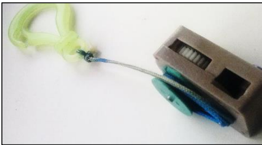
Fig. 7 Mecanismo modelo con engranajes y cuerda, potencialmente utilizable para impulsar agua en el rediseño del juego de rayuela del PRJ. [Fotografía de los autores]
