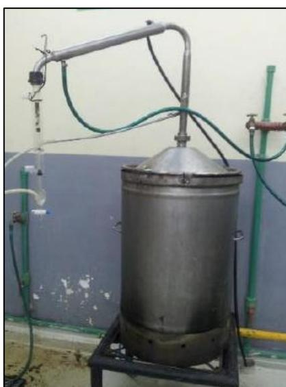
**Figura 5.** Equipo de destilación por arrastre de vapor
