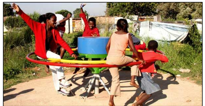
Fig. 22. Play Pump, una atracción infantil para bombear agua con energía humana y diversión. [Tomado de: http://www.terra.org/categorias/articulos/aplicaciones-domesticas-con-energia-humana ]
