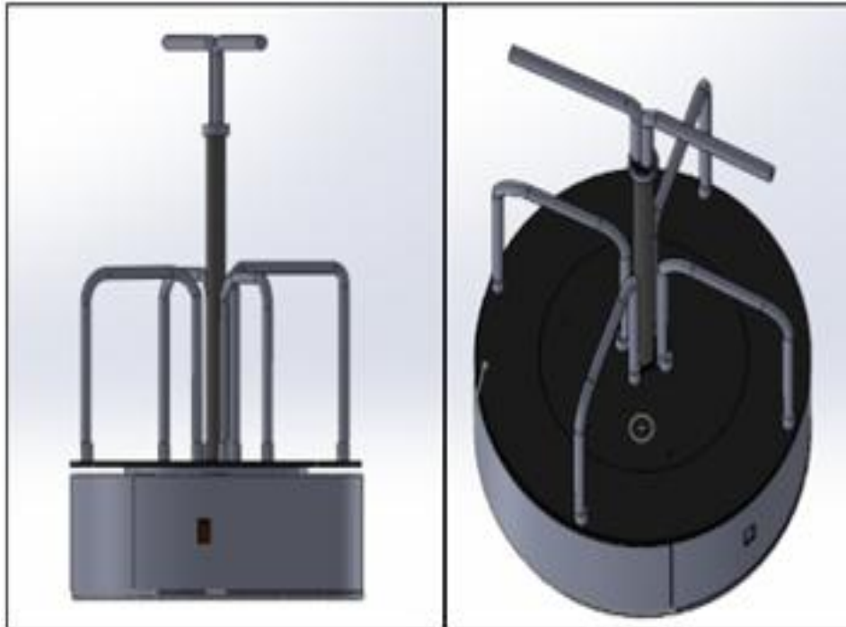
Fig 3.18. Panorámica de la propuesta del carrusel generador de energía eléctrica para el RPJ. Diseño de los autores.
