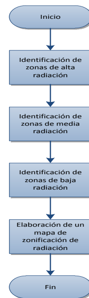
Fig 3. Metodología de trabajo para la identificación de las potencialidades del aprovechamiento de energía solar en el PR Jipiro. Diseño de autores.
