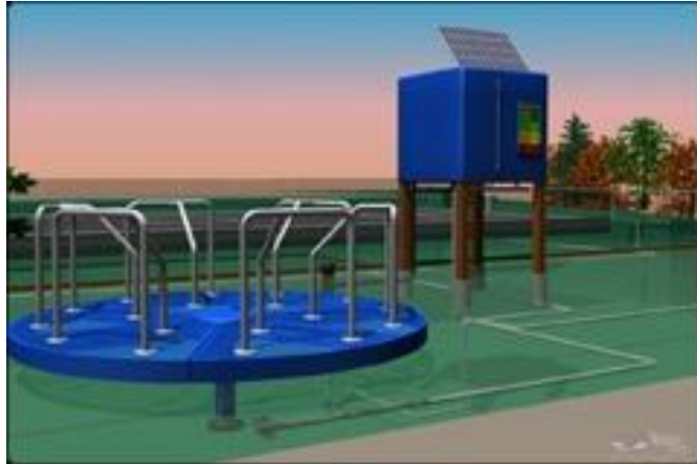
Figura.3.10. Equipo para generar energía eléctrica de Water Power Peace Project
