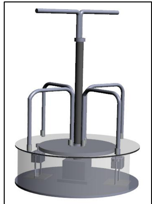
Fig 12. Propuesta de carrusel itinerante para generación de energía eléctrica. Diseño del grupo de trabajo.
