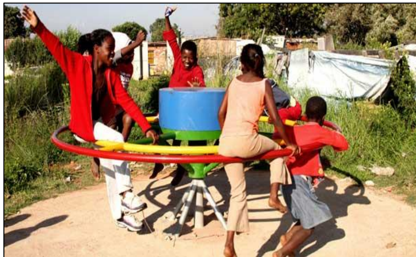
Figura.3.5. Play Pump, una atracción infantil para bombear agua con energía humana y diversión. Fuente: http://www.terra.org/categorias/articulos/aplicaciones-domesticas-con-energia-humana
