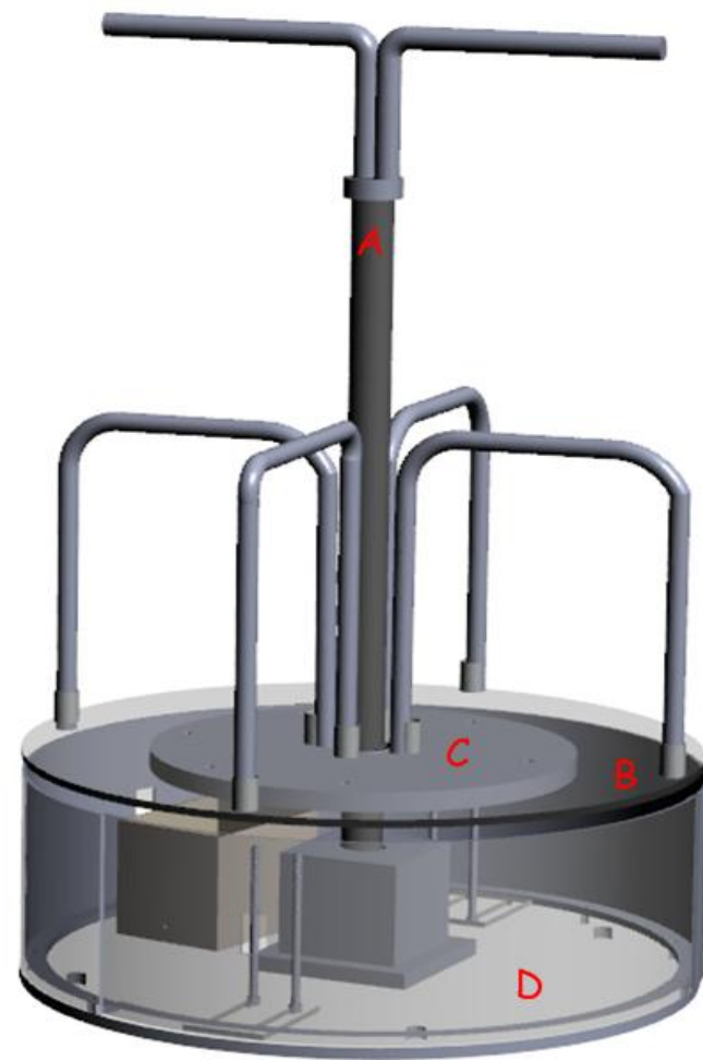
a) Vista general de carrusel generador de energía eléctrica. A-eje principal, B-plataforma de soporte C-plataforma de generadores; D- base
