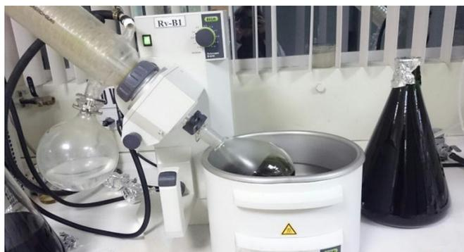
**Figura 4:** Equipo de Rotaevaporación.
