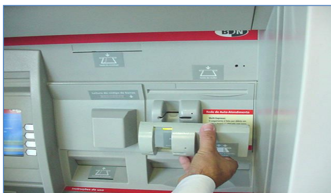
Ilustración 16: Montaje de lectora falsa
