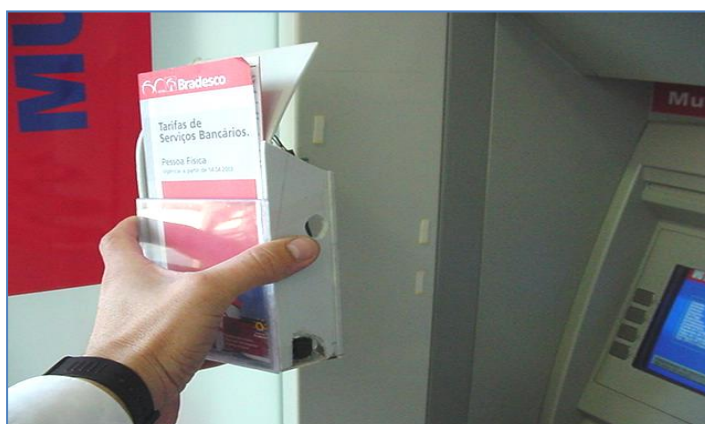
Ilustración 19: Cámara para obtención de clave
