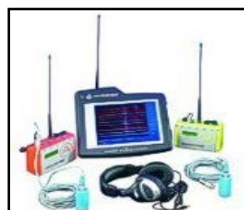
Figura 4.8. Equipo de correlación acústica
