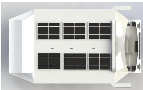
Figura 17. Arreglo de los módulos GSP80Q en la cubierta superior del bus.
