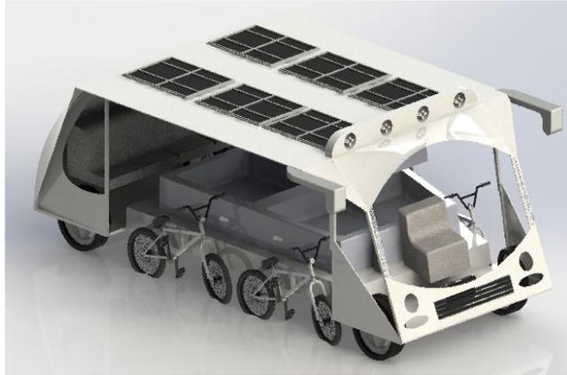
Figura 5. Vista general del quinto prototipo, que incluye protección de la acción de las llantas, y casilleros para los usuarios.
