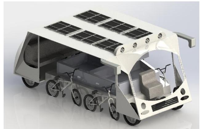
**Fig.5.** Vista general del quinto prototipo, que incluye protección de la acción de las llantas, y casilleros para los usuarios. [Diseño de autores].
