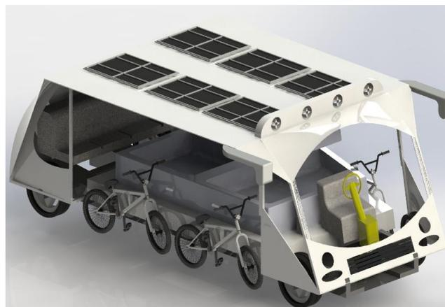
**Fig.19.** Ubicación de los puntos de captura de energía en el prototipo [Diseño de los autores].
