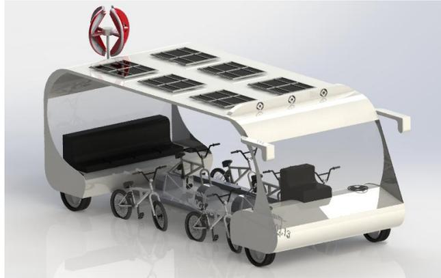
Figura 3. Vista general del tercer prototipo, que incluye el aspecto de un bus urbano convencional, y reduce el peso de la estructura.
