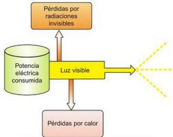
Figura 2. Transformación de la potencia en luz
