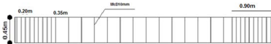
REFUERZO TRANSVERSAL PÒRTICO DE 5 PISOS SIN DISEÑO SISMORESISTENTE (VIGA)
